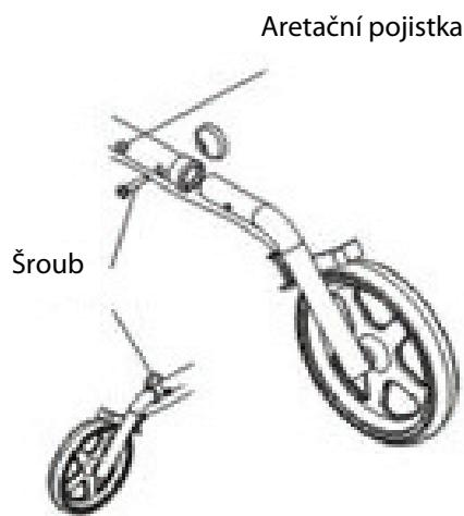
Zkontrolujte správnou polohu rychloupínacího úchytu vidlice předního kola, tak aby nebylo možné tahem opačným směrem uvolnit přední kolo z rychloupínacího úchytu.
