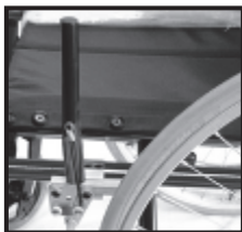
Prodloužené odnímatelné páky brzd.
