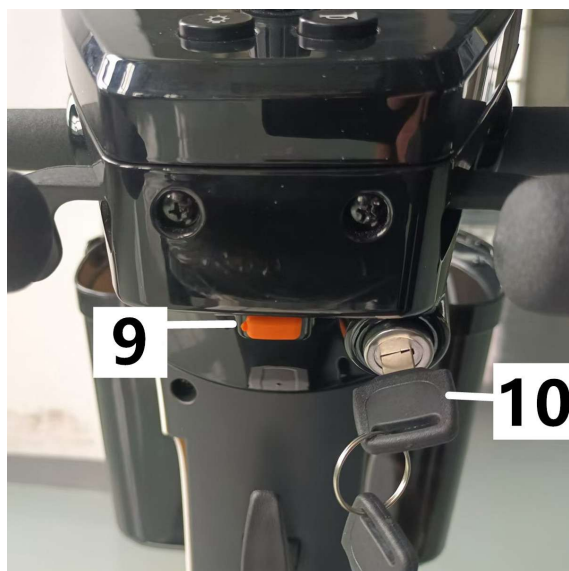
Obr. 4 - USB zásuvka (9) a spínací skříňka (10).
