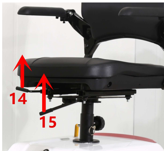
Obr. 6 - Páčka podélného nastavení (14) a páčka otáčení sedadla (15).
