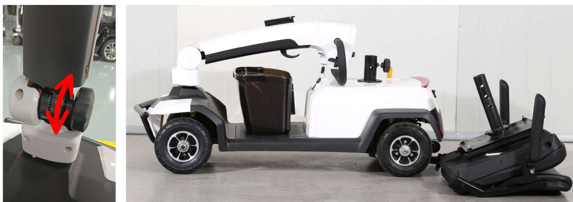
Obr. 7 - Uvolnění kloubu řídicího sloupku a příklad složeného vozíku se sejmutým sedadlem.
