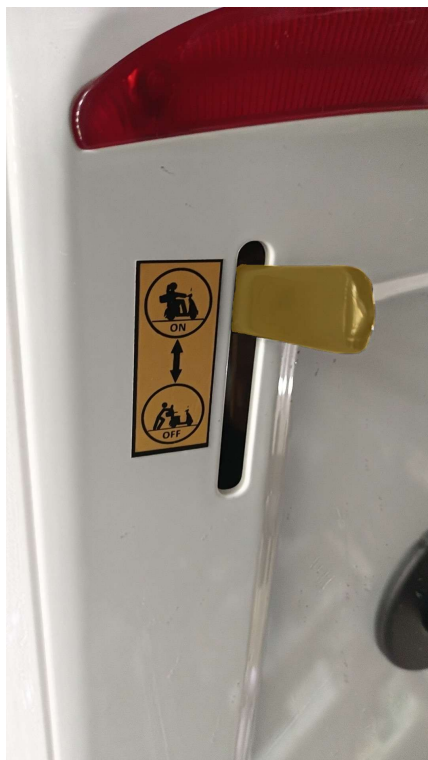
Obr. 8 - Páčka elektromagnetické brzdy: ON pro jízdu, OFF pouze pro ruční tlačení.
